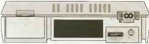
LINKS SEHEN SIE DEN ERWEITERUNGSPORT, WO U. A. DAS MPEG-MODUL EINGESETZT WIRD. RECHTS UNTEN IST DER AV-AUSGANG, SOWIE DIE LINKBUCHSE ZUR VERBINDUNG DES SATURN MIT DER AUSSENWELT.
